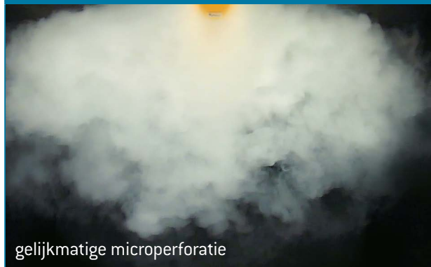
Voorbeelden van luchtstroompatronen gemaakt met rookproeven in het Přihoda R & D centrum
