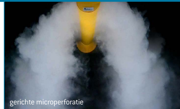
Voorbeelden van luchtstroompatronen gemaakt met rookproeven in het Přihoda R & D centrum
